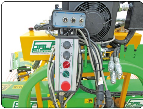
Quadro comandi e radiatore Control panel and heater Bedienfeld und Heizgeräte
