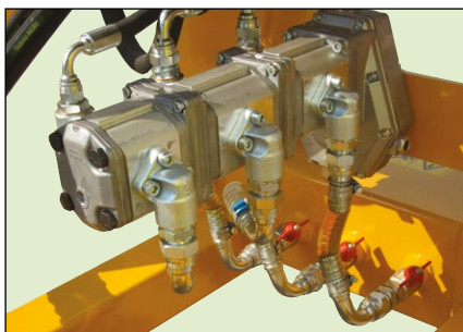
Gruppo pompe tripla Triple pumps unit Drei-Pumpen-Einheit Groupe de pompes triple
