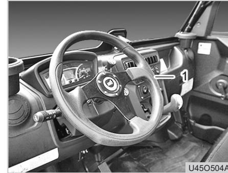
(1) Elektrisches Servolenkrad
