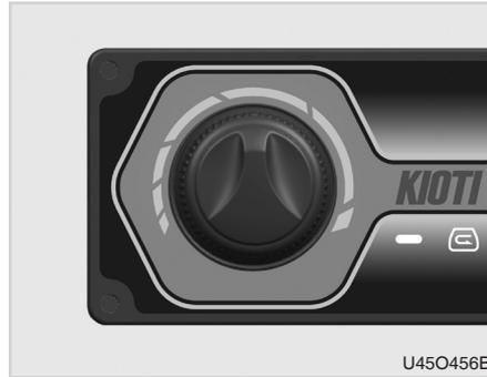
Mit diesem Regler stellen Sie die gewünschte Heiztemperatur ein. Je weiter man im Uhrzeigersinn dreht, desto wärmer die austretende Luft.
