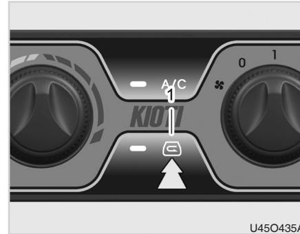
(1) Umschalter für den Belüftungsanschluss
