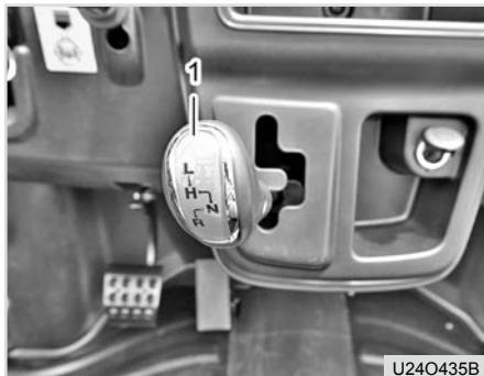
(1) Schalthebel H: Hoher Gangbereich L: Niedriger Gangbereich N: Neutral R: Rückwärts
