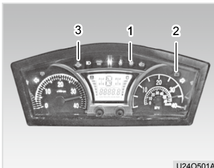
(1) Vorglühmeldeleuchte (2) Batterieladen-Warnlampe (3) Motoröldruck-Warnlampe
