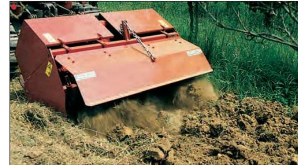
Die Spatenmaschine muß mittels einer Standard-Dreipunkthängung an den Schlepper gekoppelt werden. Sie wird durch den Zapfwellenanschluß angetrieben und erfordert keine Zugkraft.
