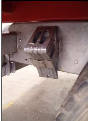
Abb. 8.7 - Unterlegkeil und Sitz
