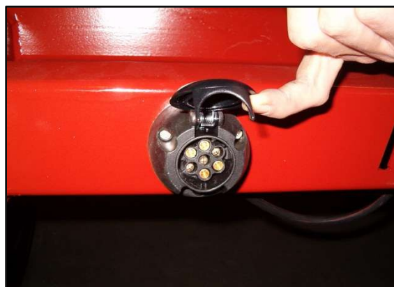
Abb. 2.2 - Steckdose für elektrischen Anschluss mit entsprechender Absicherung
