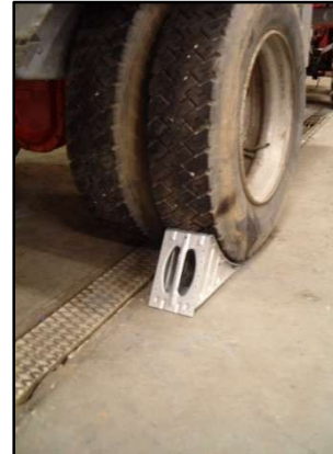
Abb. 8.8 - Richtige Positionierung am Rad
