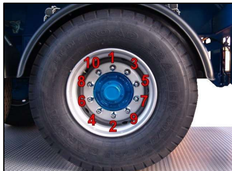
Reihenfolge des Anziehens der Muttern.
