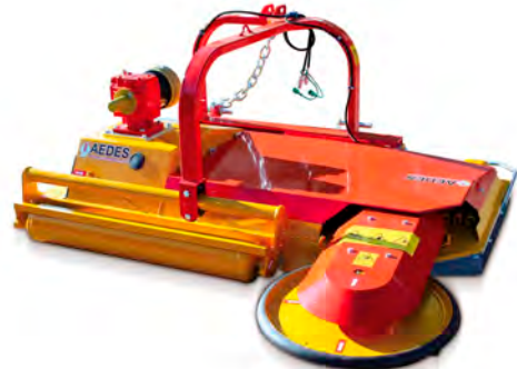
RM Sichelmulcher mit einseitiger Schwenkscheibe von 1,75 bis 3,0 m Arbeitsbreite
