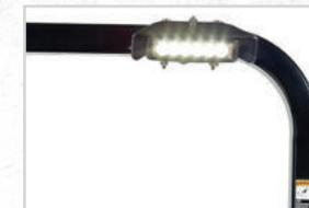
**Satz LED-Scheinwerfer – Befestigung am Überrollschutzaufbau**
